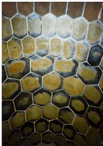
Čedičové vyložení cyklónu v cementárně
